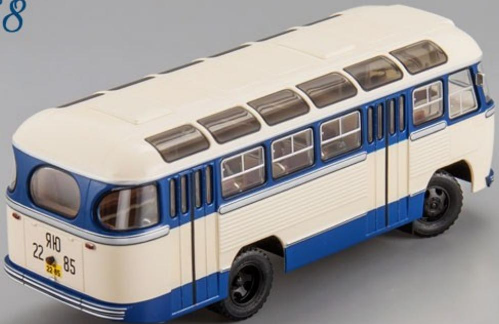
В отличии от версии 1958 года, версия 1960 года имеет: выштамповки на ширмовых дверях; на скатах крыши габаритные огни ("поворотники" от ГАЗ-51), другой щиток приточной вентиляции; сзади появились "поворотники" и световозвращатели; оснащена упрощенными бамперами; кроме того - отсутствуют молдинги облицовки передка.
