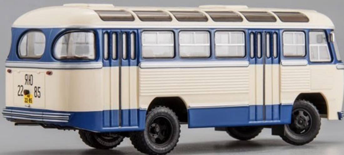
В отличии от версии 1958 года, версия 1960 года имеет: выштамповки на ширмовых дверях; на скатах крыши габаритные огни ("поворотники" от ГАЗ-51), другой щиток приточной вентиляции; сзади появились "поворотники" и световозвращатели; оснащена упрощенными бамперами; кроме того - отсутствуют молдинги облицовки передка.
