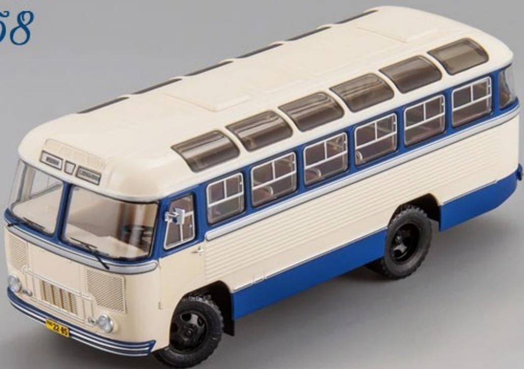
В отличии от версии 1958 года, версия 1960 года имеет: выштамповки на ширмовых дверях; на скатах крыши габаритные огни ("поворотники" от ГАЗ-51), другой щиток приточной вентиляции; сзади появились "поворотники" и световозвращатели; оснащена упрощенными бамперами; кроме того - отсутствуют молдинги облицовки передка.
